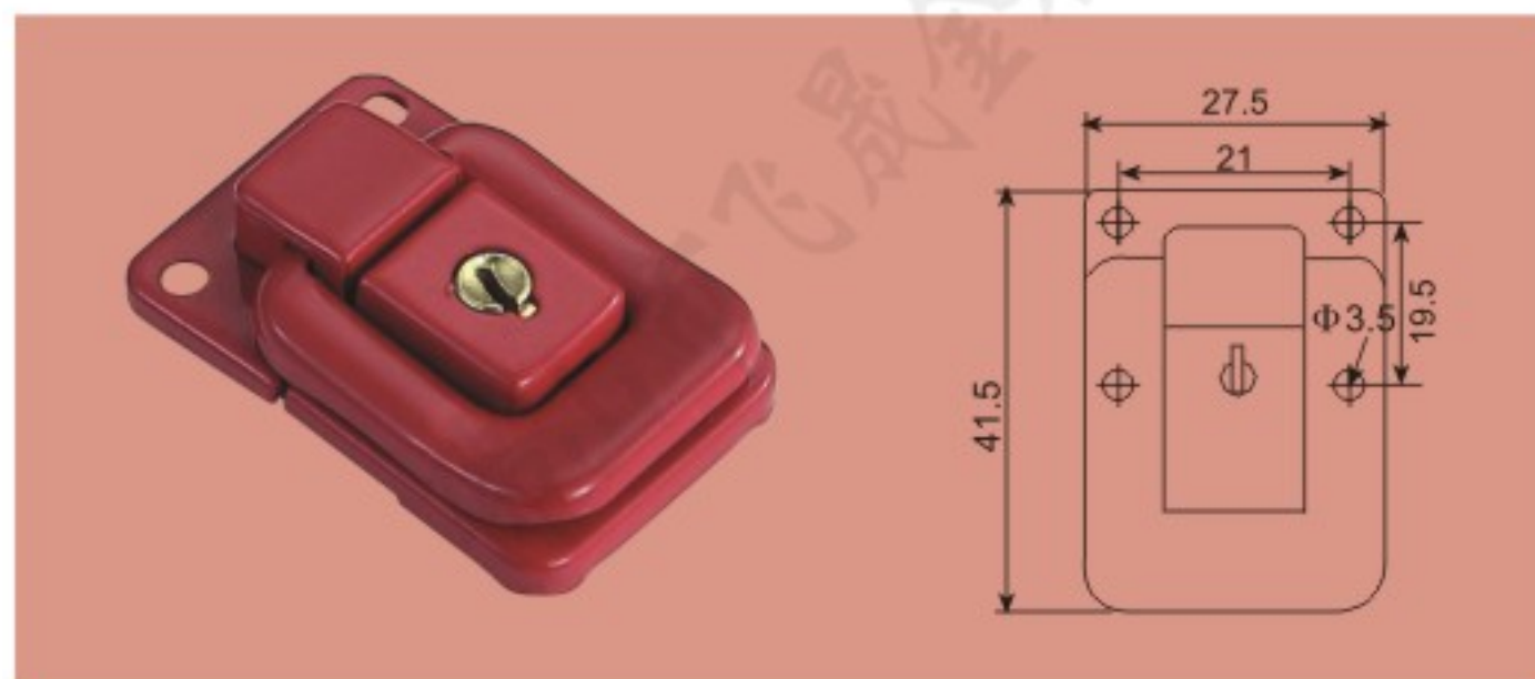
FS-1051 有匙小板扣锁(有级边孔) 41.5×27.5mm 主要材质: 冷板 Material: Cold plate 表面处理: 红色/金色/挂铬 Finished: Red/Golden/Chrome
