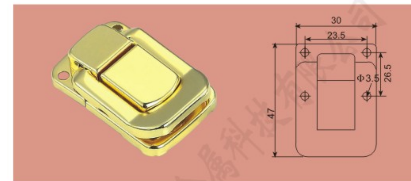
FS-1056 无匙大板扣锁(有级中孔) 47×30mm 主要材质: 冷板 Material: Cold plate 表面处理: 金色/挂铬/黑色 Finished: Golden/Chrome/Black
