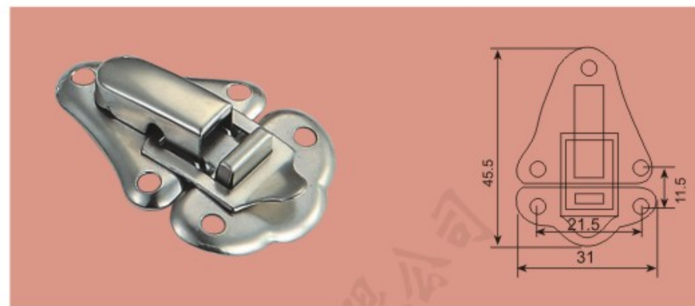
FS-1044 平底提琴式小锁 45.5×31mm 主要材质: 冷板/铁线 Material: Cold plate/Iron wire 表面处理: 金色/挂铬/黑色 Finished: Golden/Chrome/Black
